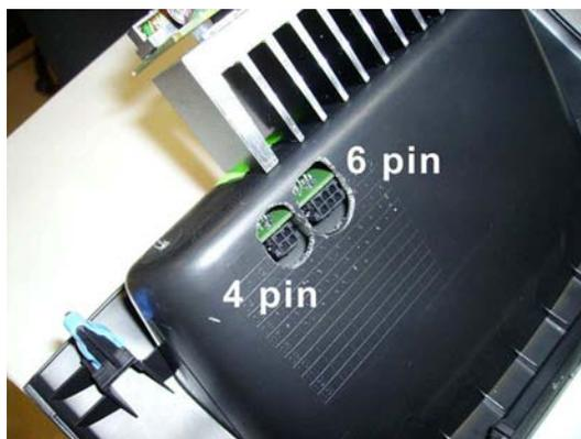
25 Collegare il connettore a 6 pin, proveniente dal **Cavo dedicato plancia Geosat (B2)** col connettore alla base della plancia
