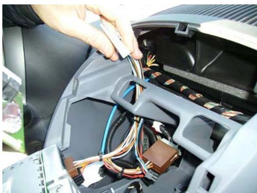
23 Collegare il connettore lungo bianco al circuito dell'amplificatore
