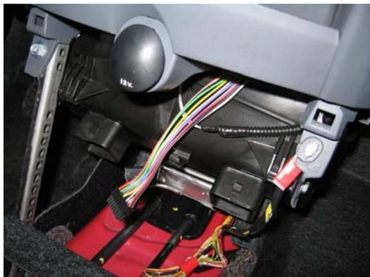
16 Bloccare il **cavo dedicato interfaccia iPod® (A5)** con del nastro adesivo sul fascio cavi vettura
